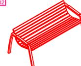
Banco Verano | fabricante De Lazzari Mobiliário Urbano | dimensões (largura x altura x profundidade): 180 x 72 x 85 cm. Suporte em aço zincado para proteção anti-corrosão, acabamento em pintura a pó eletrostática, assento em madeira sarrafeada jatobá.
