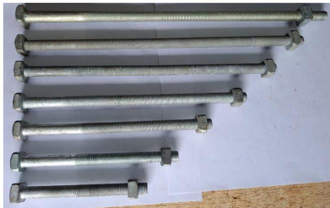
Figura 51 - Parafusos cabeça quadradas.
